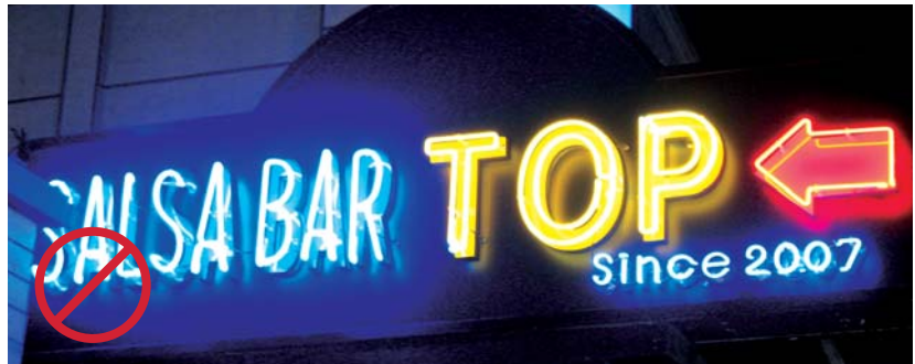
지양 사례 2 _ 광원이 노출된 점멸방식의 조명
